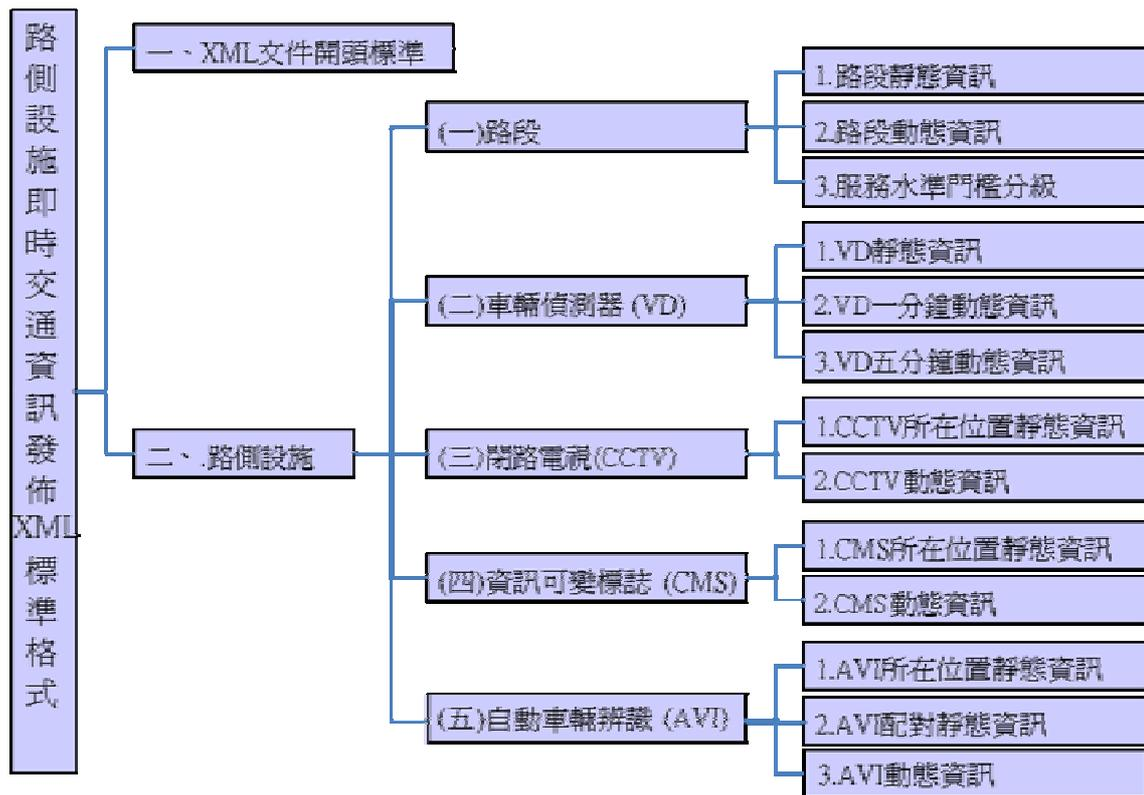
圖 1.2-1 XML 標準格式架構示意圖
